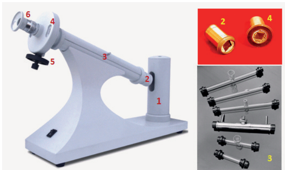
1-burimi i dritës; 2-polarizatori; 3-gyp e polarimetrash me gjatësi dhe forma të ndryshme; 4-shkallë rrethore me noniusin; 5-rregullatori; 6-okulari
