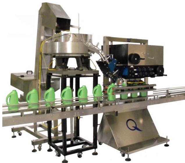
Fig.3.30. Makina e vendosjes së kapakëve me mekanizmin me aks spinot
