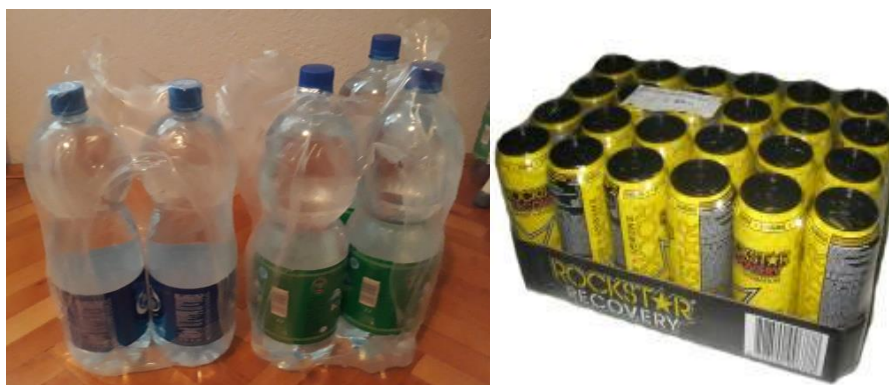
Fig.4.19. Produktet e mbështjella më film (najllon) në paketim sekondar
