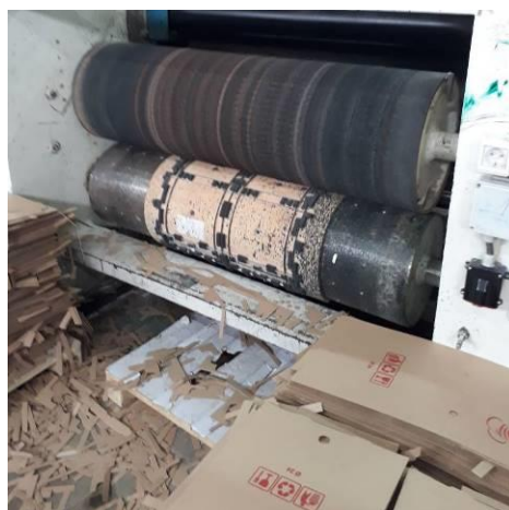
Fig. 4.6. Makina me cilindra për printim të etiketës në paketa
