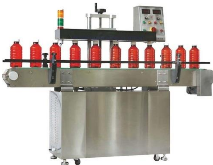
Fig. 3.25. Makina inline e vendosjes së kapakëve në shishe të plastikës
