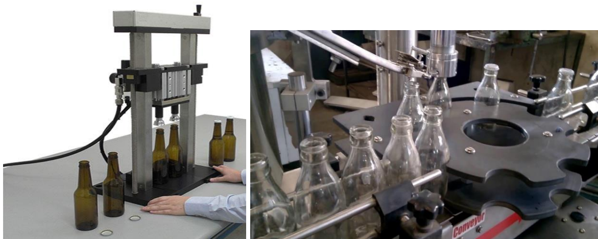
Fig. 3.32. Makinat pneumatike për mbyllje të kapakëve me presion jashtë shishes
