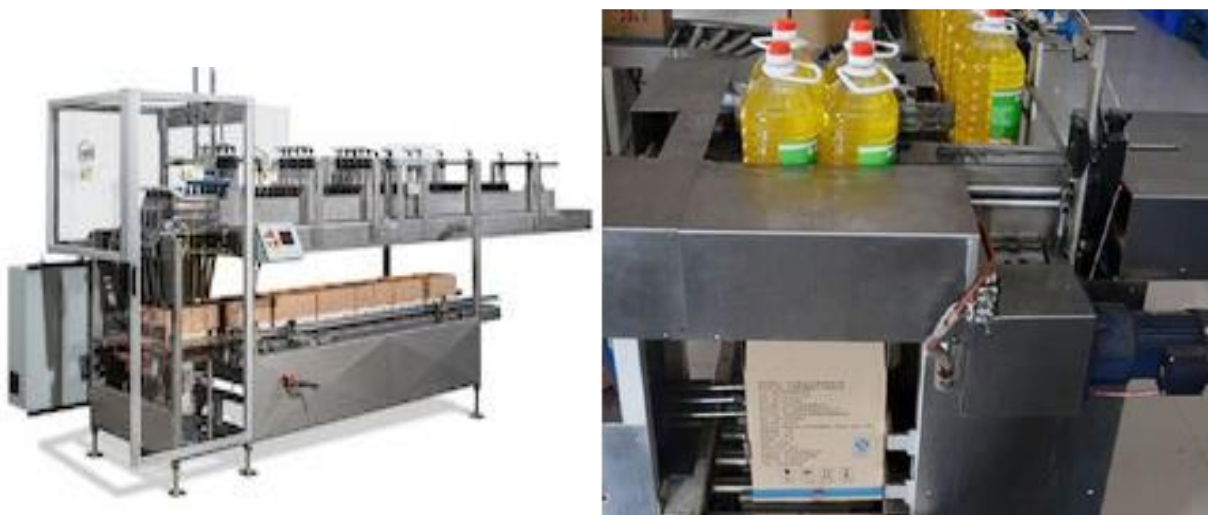
Fig.4.10.a. Makina për lëshim të produkteve në paketë (Drop Packer)
