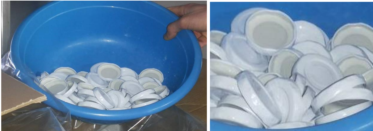
Fig.3.35. Kapakët me teh për mbyllje me presion dhe rotacion
