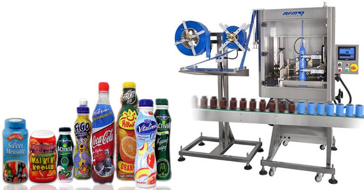
Fig. 3.56. Etiketat mbështjellëse në enë Fig. 3.57. Makina – aplikatori i etiketës veshëse në enë
