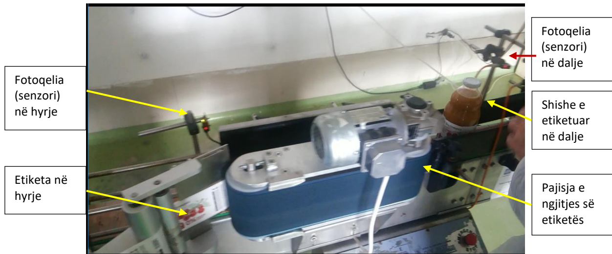
Fig. 3.55. Pamja e makinës etiketuese drejtvizore me etiketë vetngjitëse - Shiriti i etiketës në hyrje të etiketuesit dhe shishja e etiketuar në dalje
