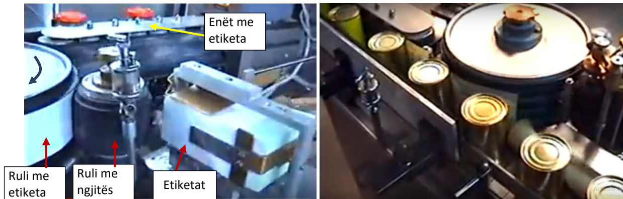
Fig. 3.50. Procesi i etiketimit i makinës me ngjitës të lëngshëm për teglla dhe konzerva
