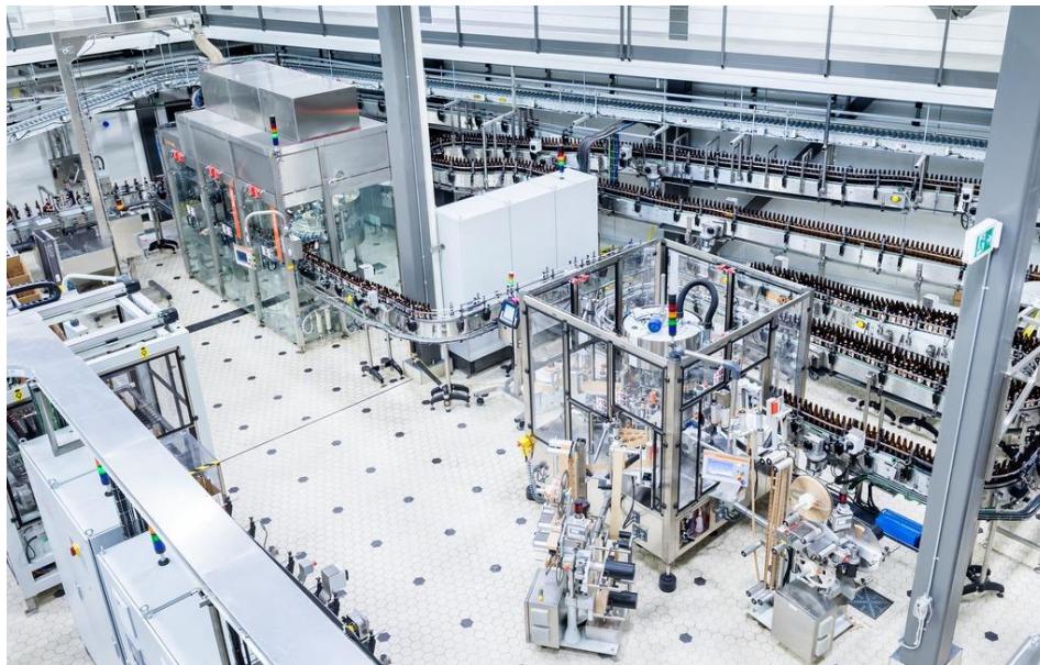
Fig.2.1. Fabrikë me linjën për mbushjen dhe paketimin e shisheve me pije
