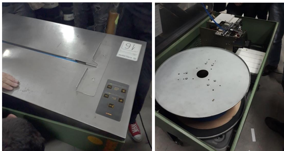
Fig.4.10. Makina për shtrëngim me shirit plastik dhe kontrollit me anë të sensorëve të shtrëngimit
