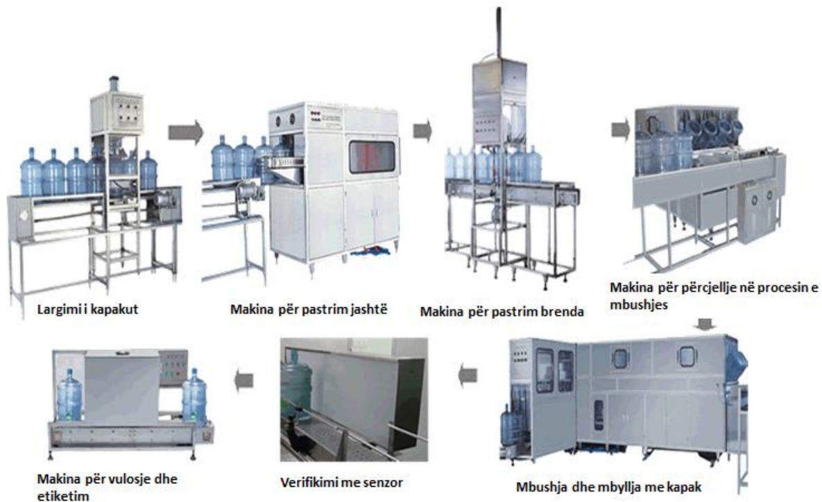
Fig. 2.3. Linja e mbushjes së bidonëve të ujit dhe përgaditja për transport
