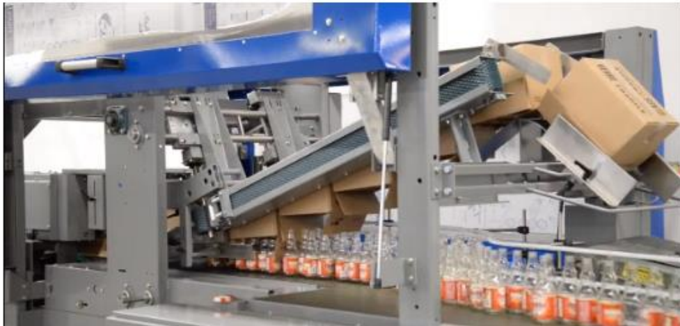
Fig.3.4. Makina që largon shishet e zbrazëta nga paketat dhe i dërgon në procesin e ardhshëm për mbushje
