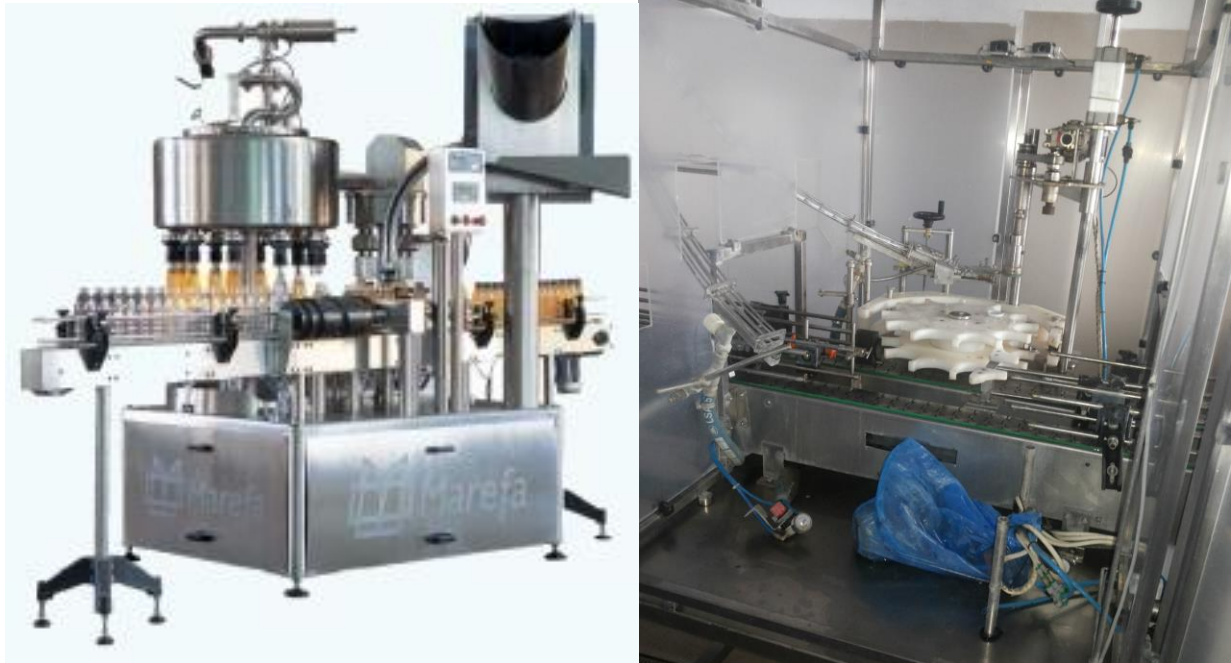
Fig.3.9. Makina mbushëse rrotulluese dhe pamja e rrotës hyrëse në formë ylli
