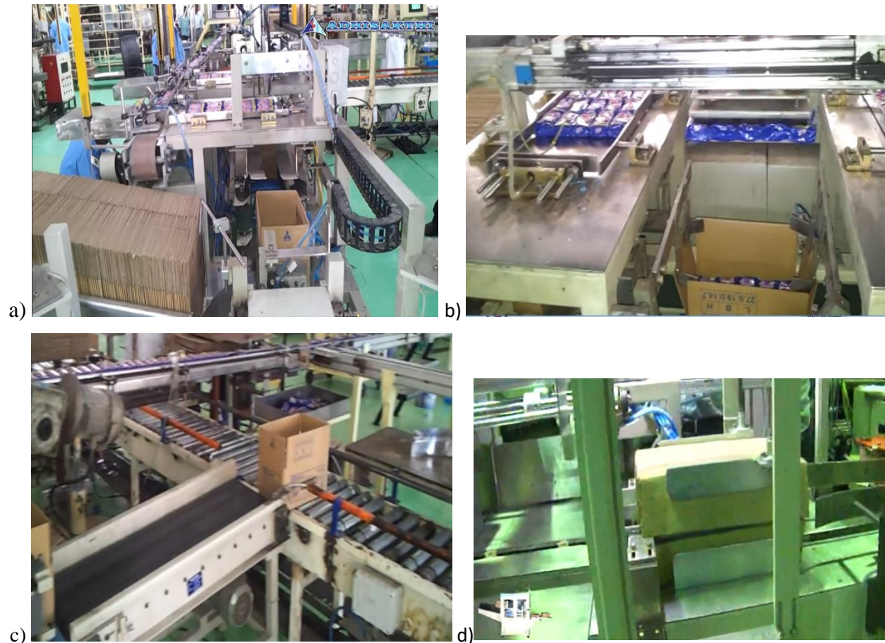
Fig.4.9. Makinat e përgaditjes së paketës, a) përgaditja e paketës nga njësia e rrafshët, b) mbushja me produkte c) përcjellja me konvejer, dhe d) mbyllja e paketës
