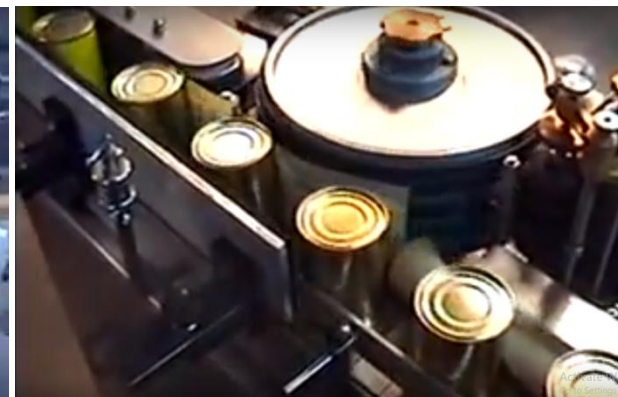
Fig. 3.50. Procesi i etiketimit i makinës me ngjitës të lëngshëm për teglla dhe konzerva
