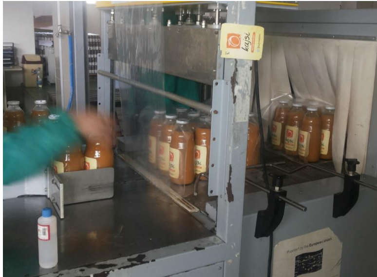
Fig. 4.20. Makina për krijimin e paketimit sekondar – mbështjellja e filmit përreth produkteve 1 . Palosja është manuale nga punëtorët
