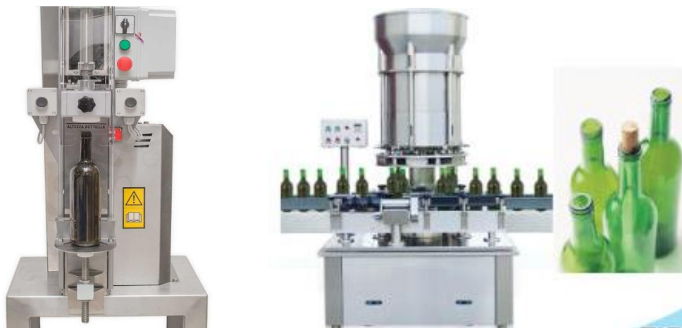
Fig. 3.33. Makinat pneumatike për mbyllje të tapës apo kapakëve me presion brenda shishes
