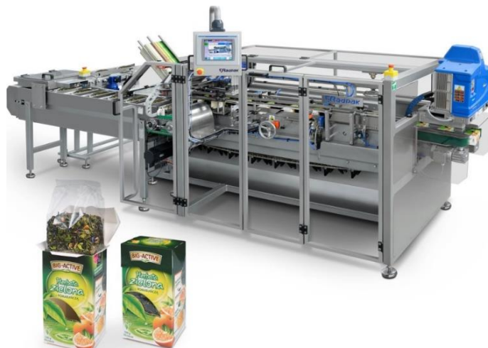
Fig. 4.4. Makinat e ndryshme për realizimin e paketimit primar nga kartonët
