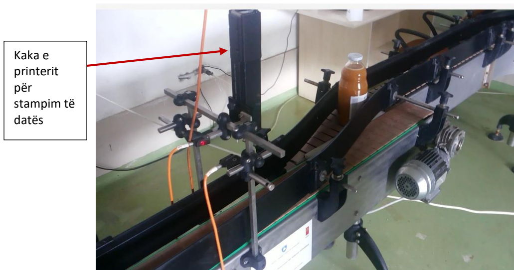
Fig.3.59. Koka e printerit për printim apo stampim të datës dhe afatit të shërbimit në kapak të shishes
