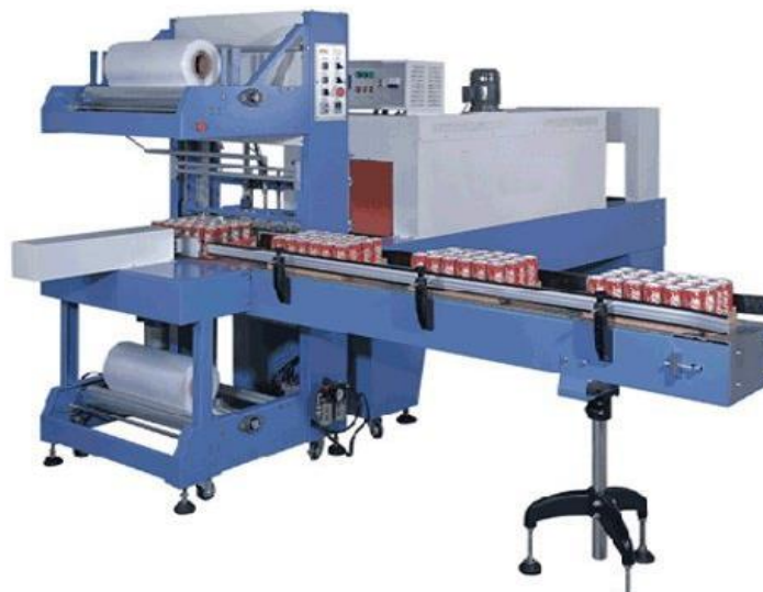
Fig. 4.21. Makina automatike për krijimin e paketimit sekondar – mbështjellja e filmit përreth produkteve
