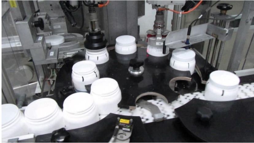
Fig. 3.27. Mekanizmi me diskun rrotullues për vendosjen e kapakëve në sistemin në linjë (inline)
