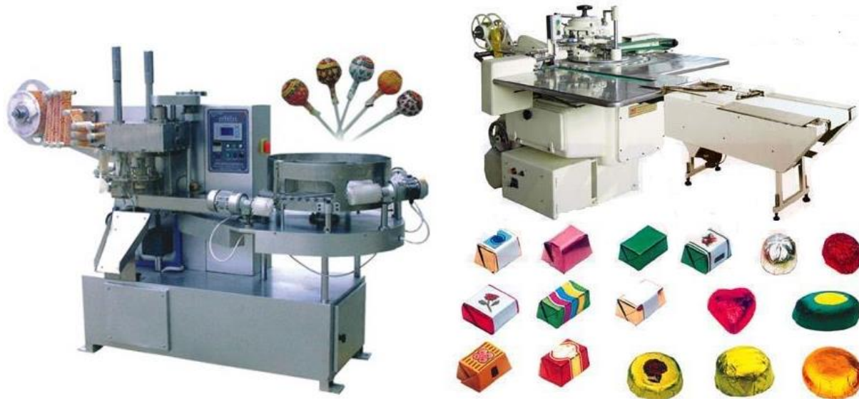
Fig. 4.18. Makinat për krijimin e ambalazhës mbështjellëse me rrotullim
